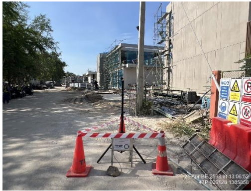
บริษัท ทีเอ็นพี เอ็นไวรอนเม้นท์ จำกัด เข้าติดตั้งเครื่องตรวจวัดเสียง
